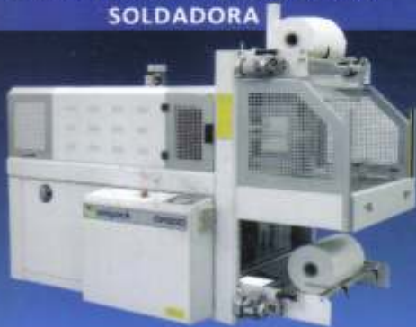
BP 800 ENFAJADORA MONOBLOQUE SEMAUTOMATICA DE FILM TERMOENCOGIBLE CON BARRA SOLDADORA
